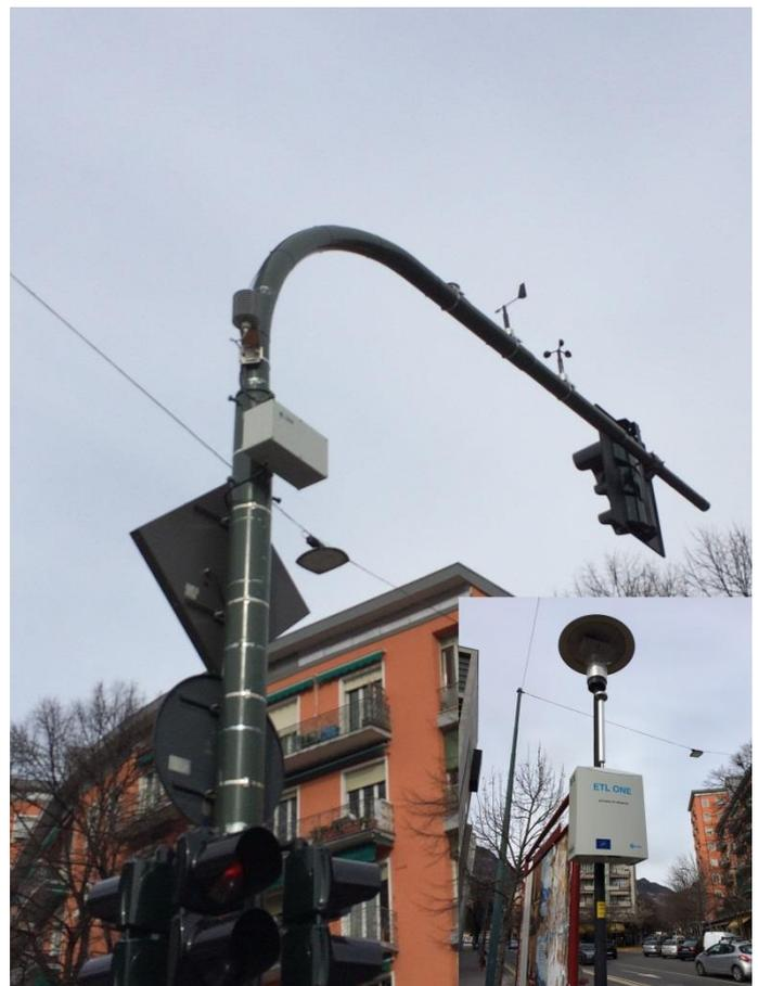
**Figura 3: La nuova stazione di misura dell'inquinamento in via Roma.**
